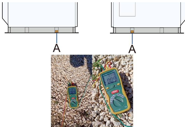
图 3-16 电阻值测量示意
