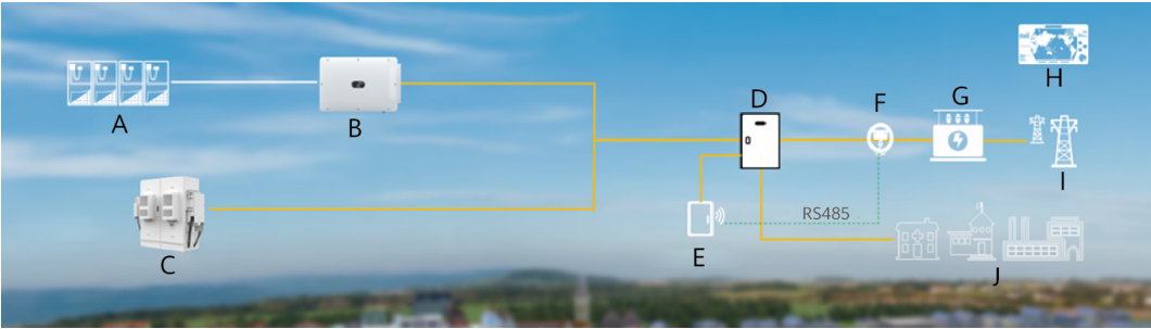
图 2-2 工商业光伏电站组网
